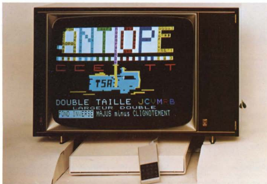
Récepteur de télévision équipé d'un décodeur ANTIOPE et de son clavier de commande. Sur l'écran la mire de test ANTIOPE-C.C.E.T.T.
